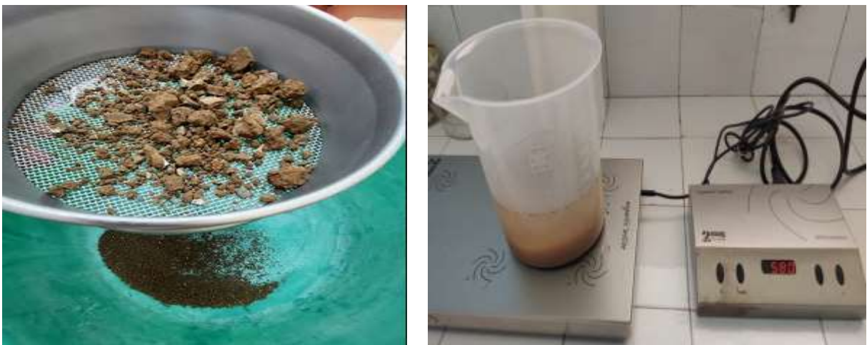
Figure (07) : Tamisage du sol
